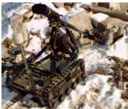
Il robot teleguidato che consente di disattivare un ordigno ad alta pericolosità.
